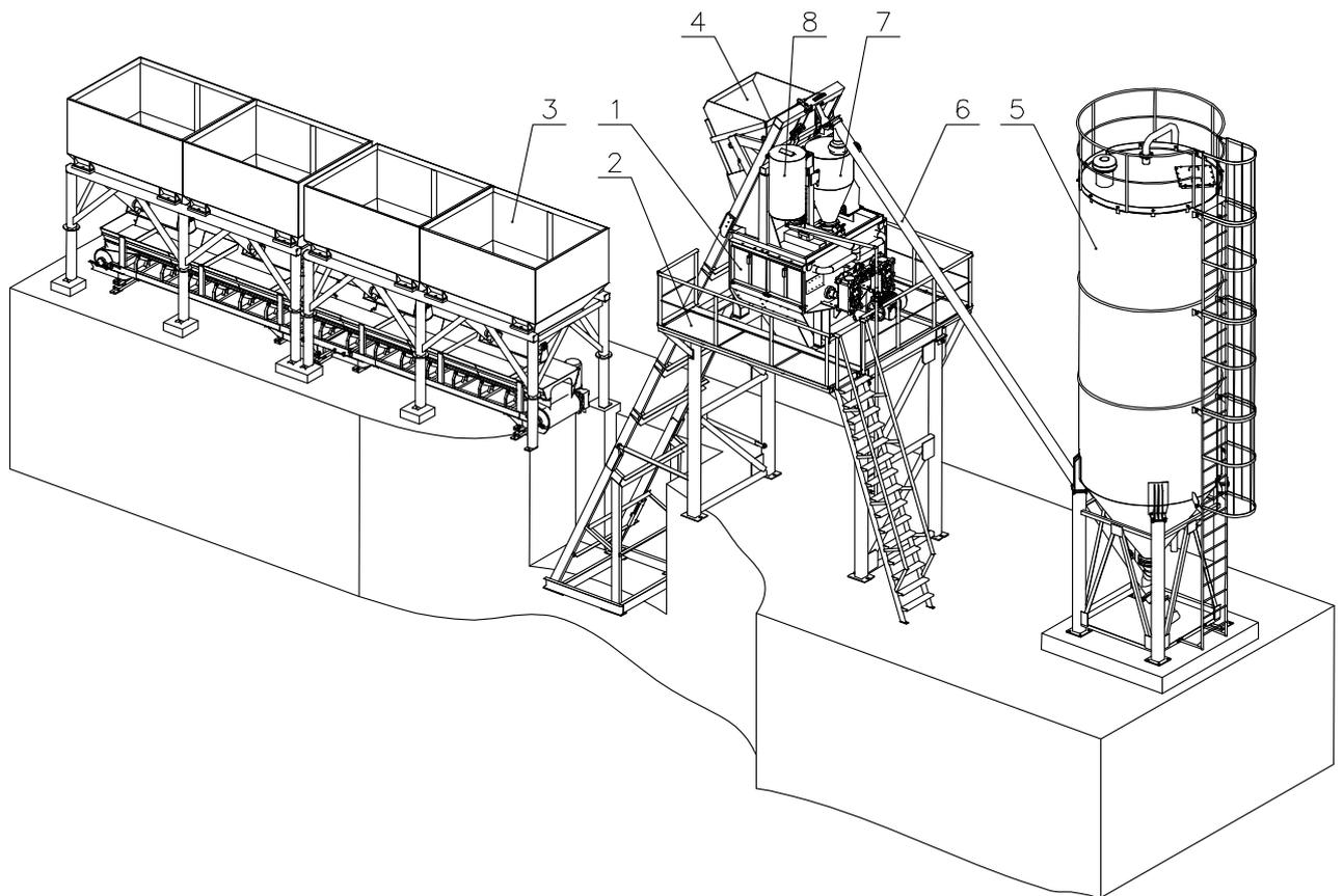
Рис. 1. Общий вид бетонного завода.
