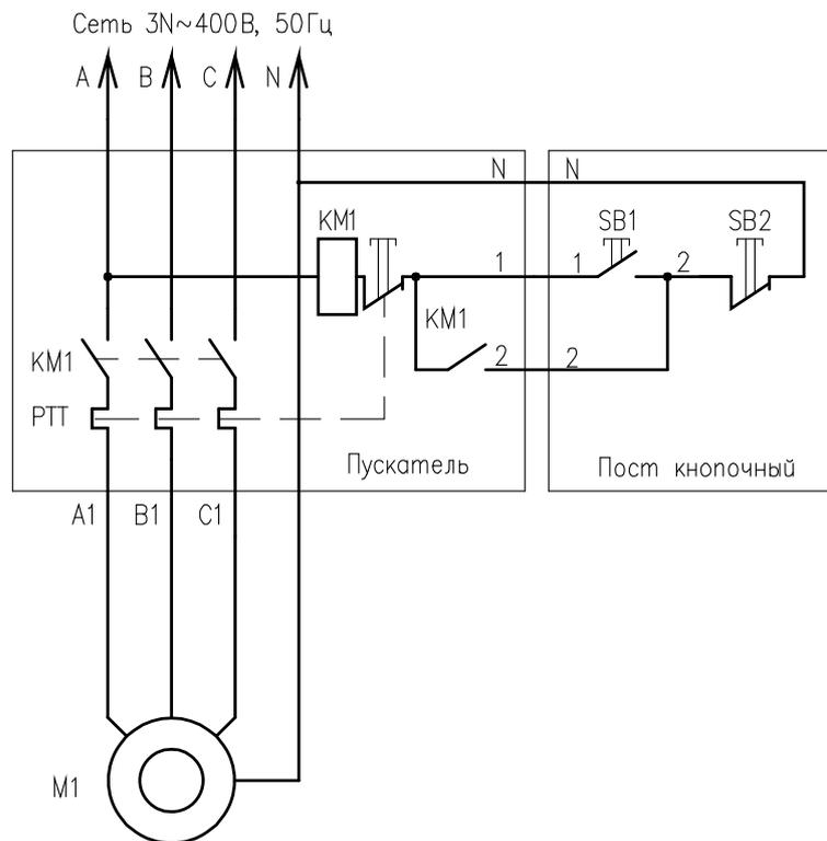
Рис. 12. Схема электрическая принципиальная смесителя.
